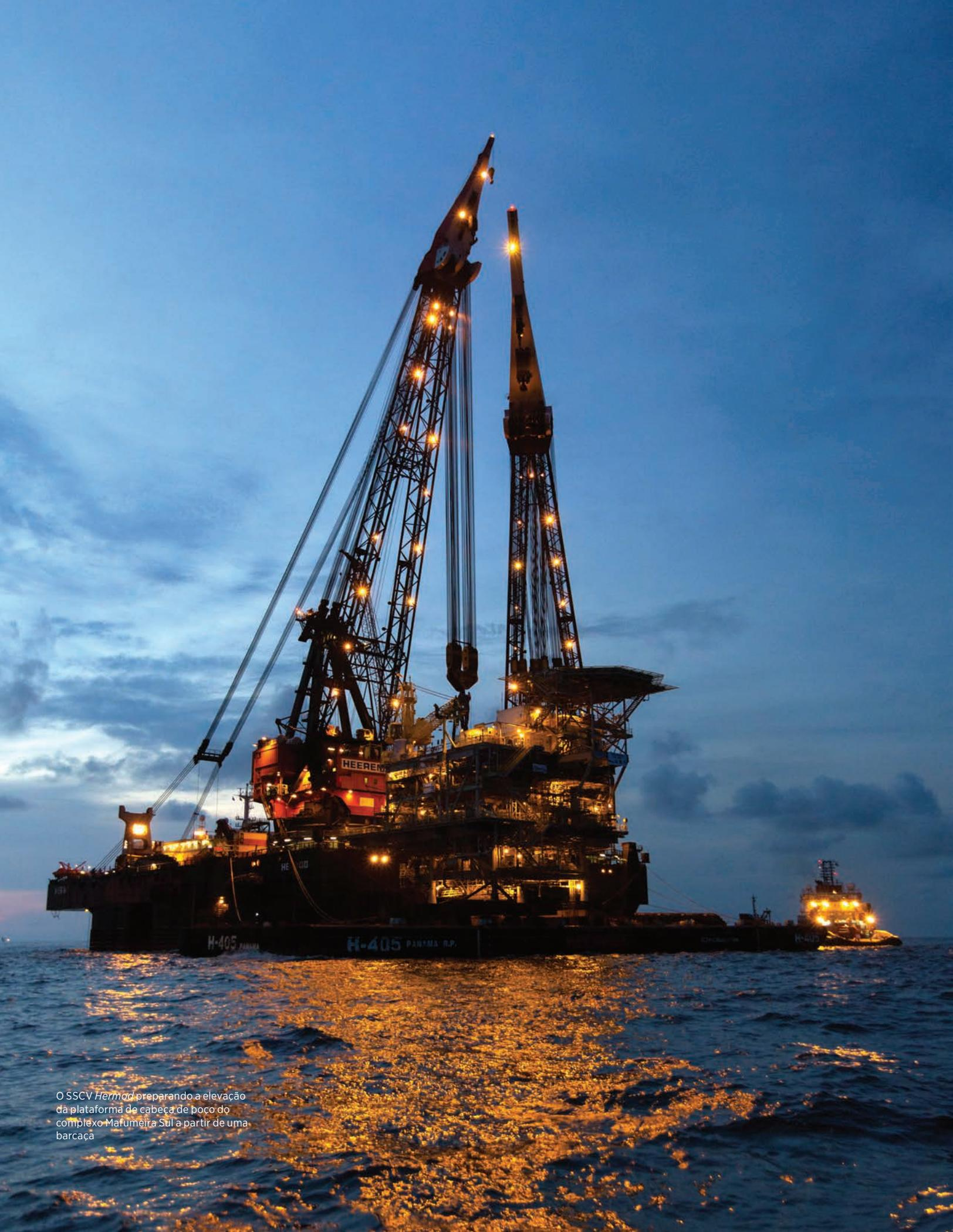
O SSCV *Hermod* preparando a elevação da plataforma de cabeça de poço do complexo Mafumeira SUL a partir de uma barcaça
